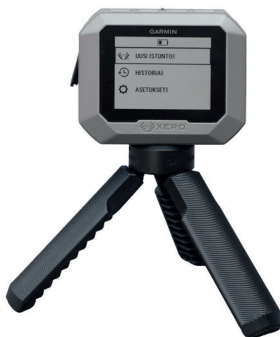
KUVA 129 Esimerkki tutkaan perustuvasta lähtönopeusmittarista
