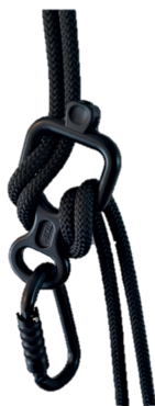
KUVA 252 Köysi, kahdeksikko ja sulkurengas asennossa, jossa ne kiinnitetään laskeutujan valjaisiin
