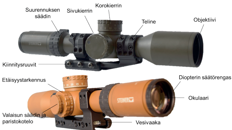
KUVA 19 Kiväärinkaukoputken ulkoinen rakenne
