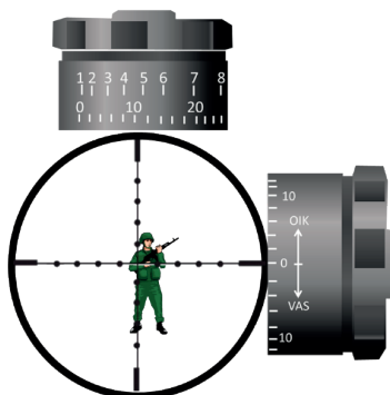
Korkeuskorjaus kiertimellä Sivukorjaus ristikolla
