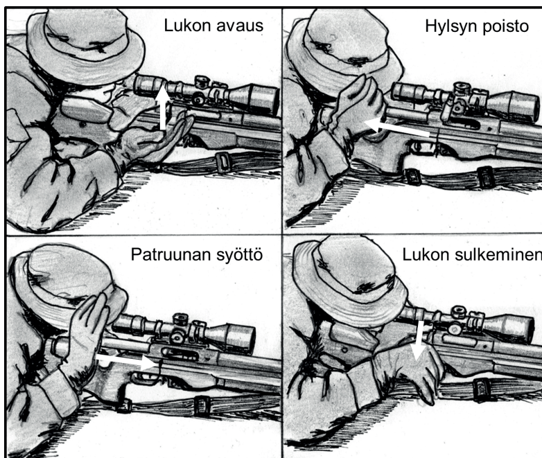
KUVA 28 Latausliikkeen vaiheet ovat lukon avaus, hylsyn poisto, patruunan syöttö ja lukon sulkeminen
