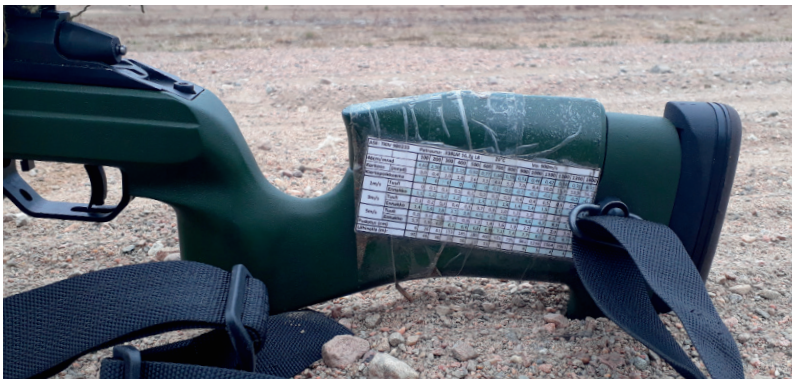
KUVA 69 Erilaisia korjaustaulukon sijoitustapoja aseeseen
